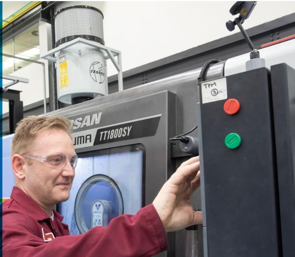
Fモニタ・エッセンシャルは風圧を測定することで適正な風量をチェックし、シンプルな3色信号灯システムによって、作業者にとって潜在的な問題の有無を容易に特定します。
